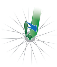
Эксцентрикóвый зажим колесных втулок
